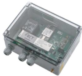
El Sistema Transmision de atos tiene alarmas a través de GPRS/4G/NB-IoT/Sigfox/LoRa al servidor en la nube para la gestión de datos a través de Mobile/Web Apps.
